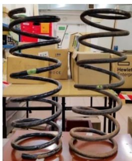
Rys. 3. Widok ogólny sprężyn: a) nowych, oznaczonych numerami 1–4, b) używanych 5 i 6, c) używanych 7 i 8 (opracowanie własne)
