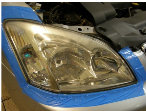
Rys. 8. Zabezpieczenie elementów sąsiadujących z reflektorem [10]
