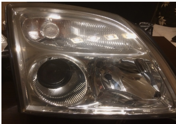
Rys. 14. Reflektor po regeneracji z samochodu Opel Vectra C 2004 rok (opracowanie własne)
