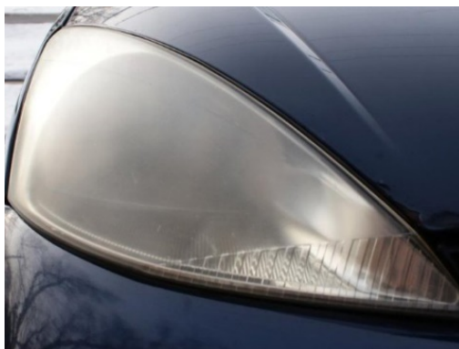
Rys. 4. Matowa i mętna szyba reflektora [10]
