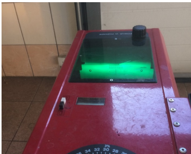
Rys. 21. Rzut plamy świetlnej świateł drogowych reflektora Skody po regeneracji (opracowanie własne)
