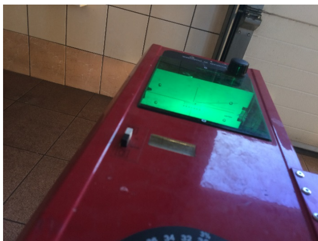
Rys. 22. Rzut plamy świetlnej reflektora Opla przed regeneracją (opracowanie własne)
