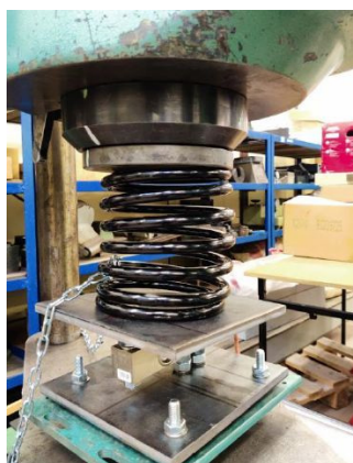
Rys. 10. Widok ogólny sprężyny odkształconej o 160 mm (opracowanie własne)
