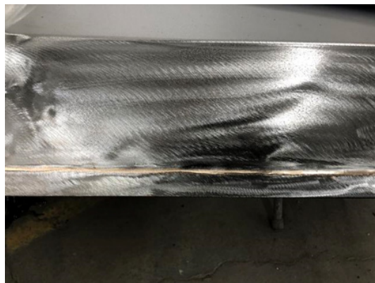
Rys. 9. Naprawa za pomocą metody lutospawania karoserii [4]
