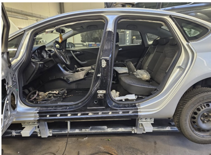
Rys. 9. Wspawane poszycie progu oraz słupka (opracowanie własne)
