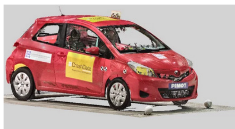
Rys. 7. Skanowanie 3D nadwozia samochodu osobowego podczas próby zderzeniowej (opracowanie własne)
