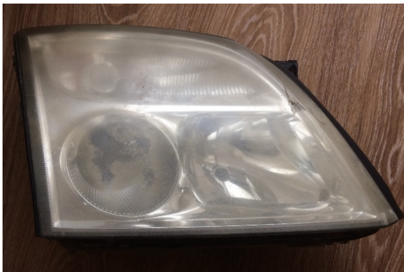
Rys. 13. Reflektor przed regeneracją z samochodu Opel Vectra C 2004 rok (opracowanie własne)
