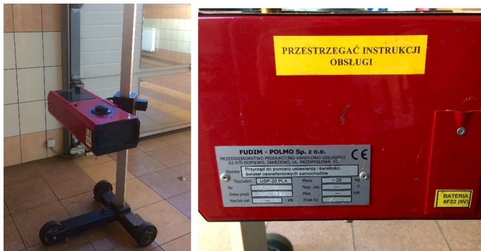
Rys. 17. Przyrząd do pomiaru ustawienia i światłości świateł oświetleniowych samochodów (opracowanie własne)
