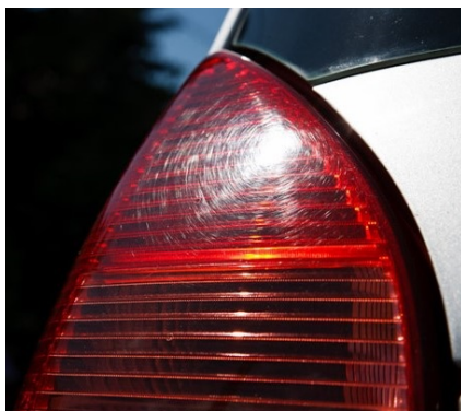
Rys. 6. Zarysowania klosza na przykładzie tylnego reflektora [10]
