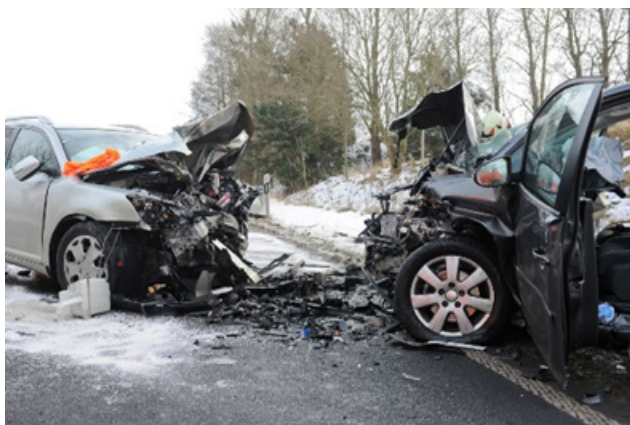
Rys. 4. Uszkodzenie czołowe w wyniku zderzenia dwóch pojazdów [6]
