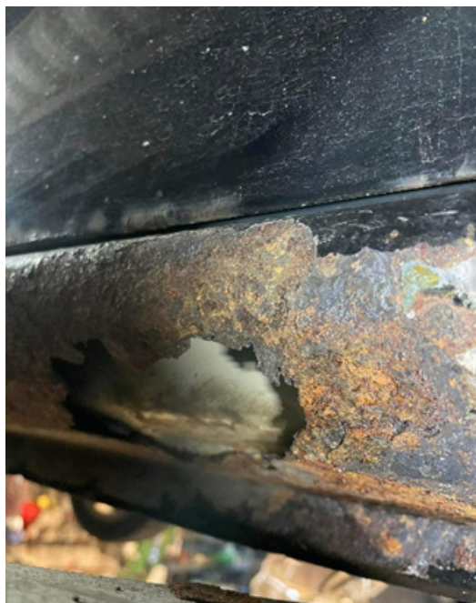
Rys. 2. Znaczna korozja progu (opracowanie własne)
