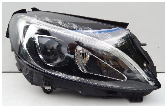
Rys. 3. Reflektor z gładkim kloszem pochodzący z Mercedesa W205 [10]
