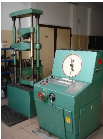
Rys. 4. Widok ogólny maszyny wytrzymałościowej ZD 40 (opracowanie własne)
