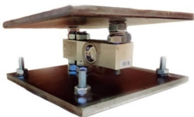
Rys. 5. Elementy składowe układu pomiarowego: a) mikrokontroler STM32 446RET6, b) wzmacniacz/przetwornik HX711, c) czujnik tensometryczny Keli SQB – A, d) wyświetlacz Waveshare (opracowanie własne)
