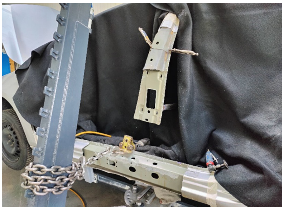
Rys. 12. Metoda naprawy karoserii z użyciem ramy (opracowanie własne)
