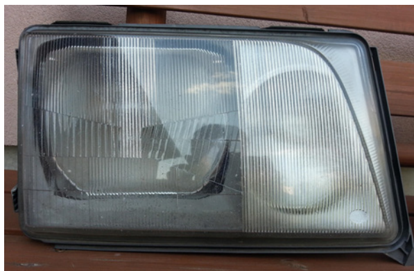
Rys. 2. Reflektor ze szklanym kloszem rozpraszającym pochodzący z Mercedesa W124 [10]
