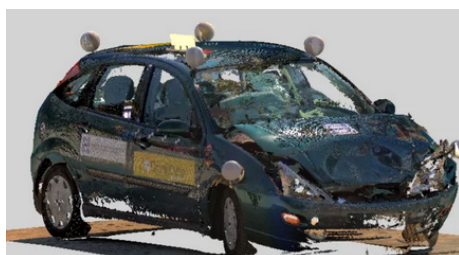
Rys. 7. Skanowanie 3D nadwozia samochodu osobowego podczas próby zderzeniowej (opracowanie własne)
