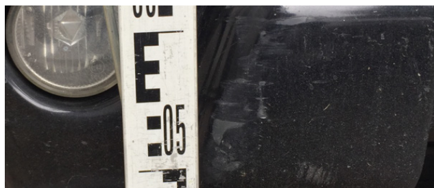
Rys. 6. Otarcie i nawarstwienie lakieru drugiego pojazdu w miejscu kontaktu nadwozi (opracowanie własne)
