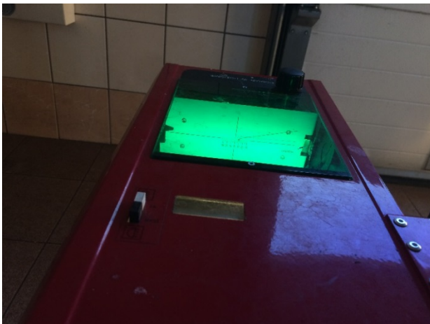
Rys. 20. Rzut plamy świetlnej świateł drogowych reflektora Skody przed regeneracją (opracowanie własne)
