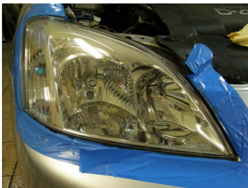
Rys. 11. Reflektor po przeprowadzeniu wszystkich etapów prac z papierem wodnym [10]
