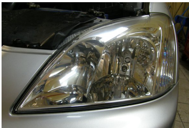
Rys. 12. Reflektor po całkowitym procesie regeneracji klosza [9]
