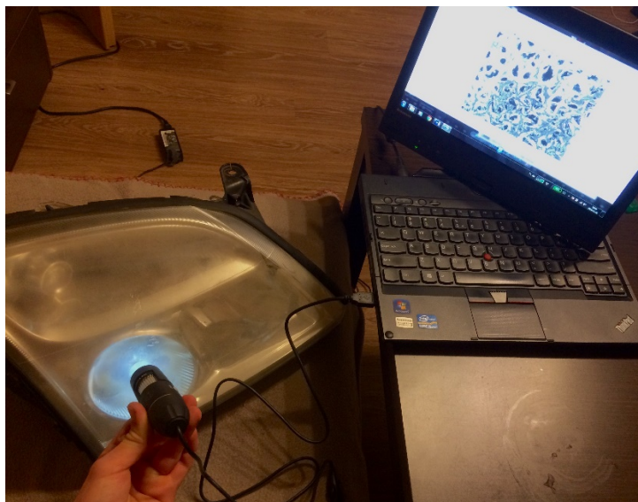
Rys. 18. Metodyka badań za pomocą mikroskopu cyfrowego (opracowanie własne)
