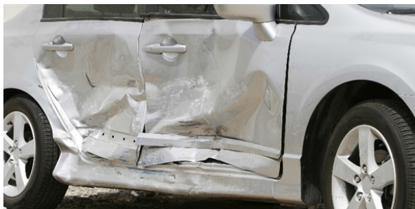
Rys. 6. Uszkodzenie boczne centralne [3]
