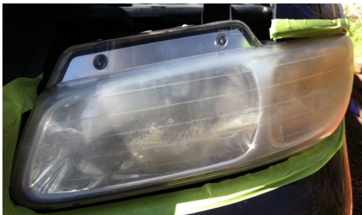
Rys. 7. Przykład wżerów, plam i odbarwień na reflektorze [9]
