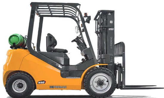
Rys. 2. Model wózka jezdniowego podnośnikowego firmy PROMAG S.A. o napędzie spalinowym zasilanym LPG [5]
