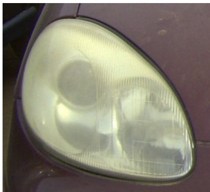
Rys. 5. Przykład procesu oksydacji klosza reflektora [9]
