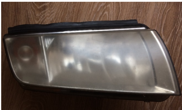
Rys. 15. Reflektor przed regeneracją z samochodu Skoda Fabia I 2006 rok (opracowanie własne)
