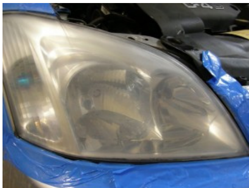
Rys. 10. Reflektor po przeprowadzeniu wszystkich etapów prac z papierem wodnym [10]
