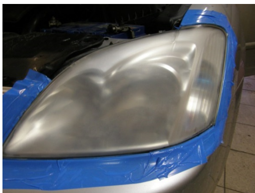
Rys. 9. Klosz po wstępnym szlifowaniu papierem wodnym o gradacjach P500 i P1000 [10]
