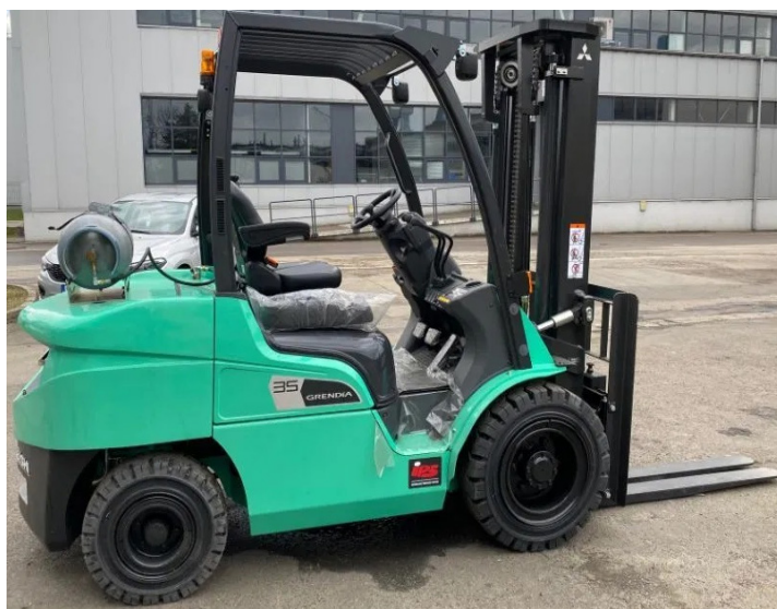
Rys. 1. Model FG35N Mitsubishi umożliwiający podnoszenie ładunku o masie do 3500 kg [3]
