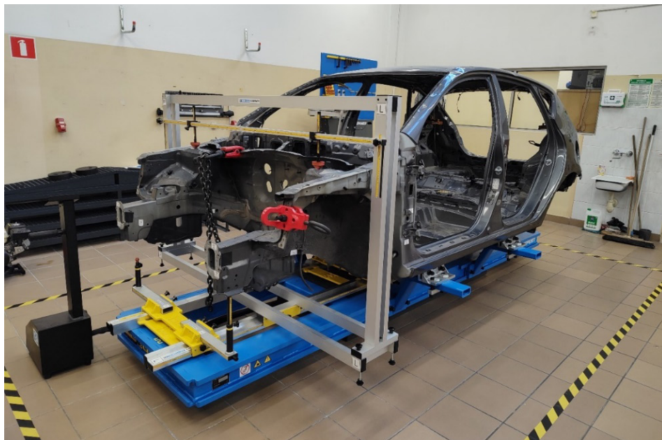
Rys. 5. Mechaniczny przymiar blacharski na nadwoziu pojazdu Hyundai i30 (opracowanie własne)
