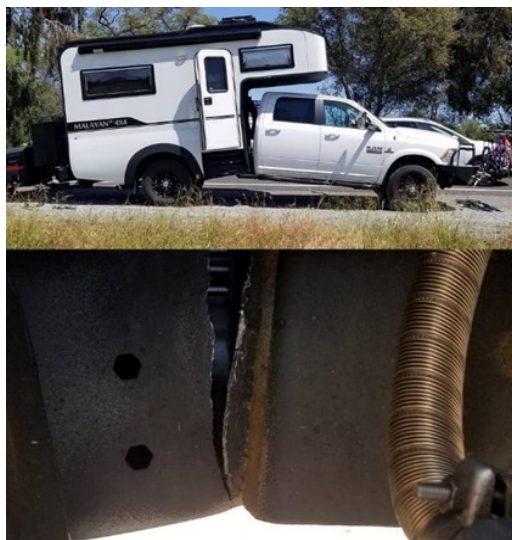
Rys. 3. Uszkodzenie zmęczeniowe karoserii [5]
