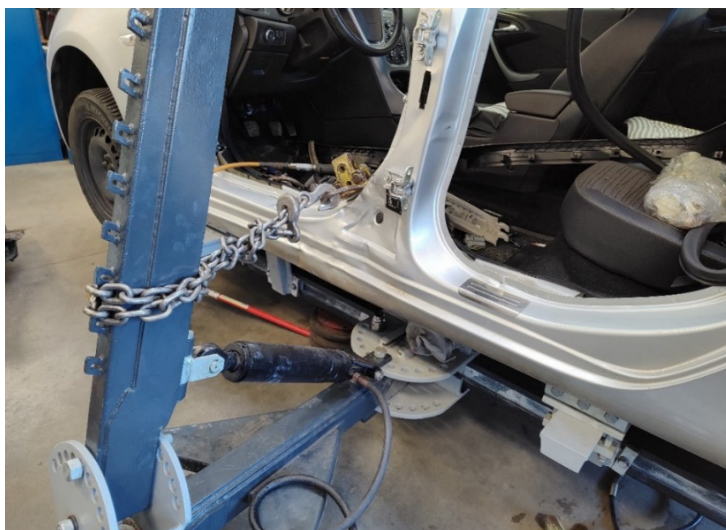
Rys. 8. Próba wyciągnięcia podstawy słupka z lewej strony (opracowanie własne)
