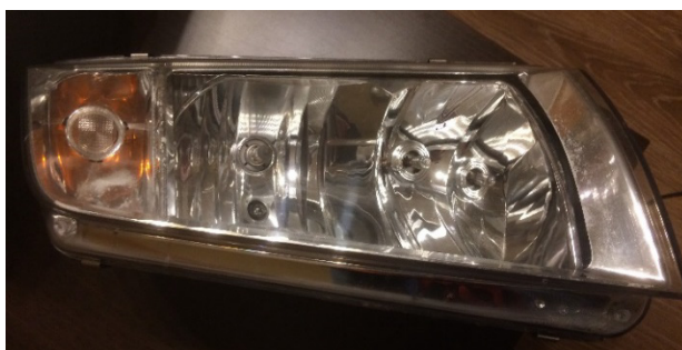
Rys. 16. Reflektor po regeneracji z samochodu Skoda Fabia I 2006 rok (opracowanie własne)
